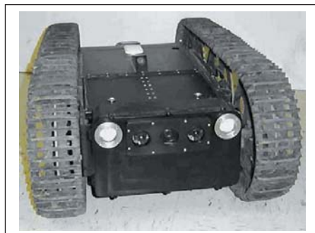
Рис. 7. Миниатюрный робот URBOT обнаружения и обхода препятствий, оснащенный стерео-видеокамерами с центральным вычислителем на базе CM-i686
