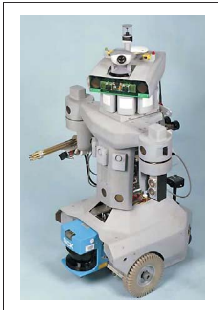
Рис. 8. Разведывательный робот ROBART III, предназначенный для обнаружения взрывчатых веществ на базе CM-i686
