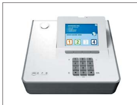
Рис. 10. Plenitude Premium — система обнаружения вторжения в помещение на базе SBC-X255
