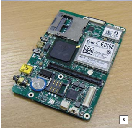
Рис. 1. Процессорная плата EM-X270: а) с ЖКИ; б) вид сверху; в) вид снизу
