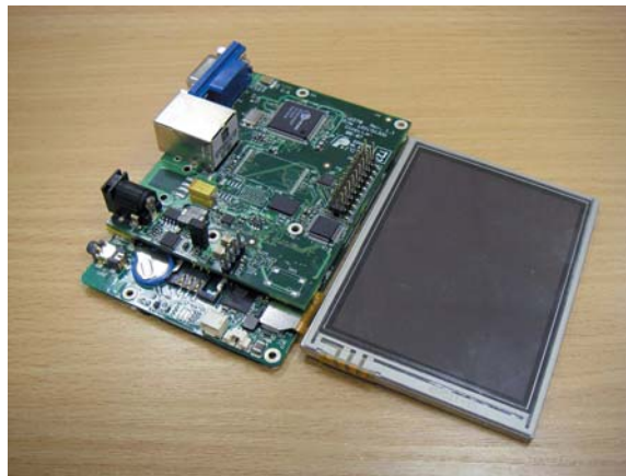
Рис. 2. EM-X270 в комплекте с платой расширения EB-X270
