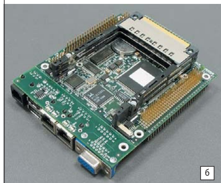
Рис. 5. Внешний вид одноплатного компьютера SBC-iGLX: а) вид с передней панелью; б) вид снизу
