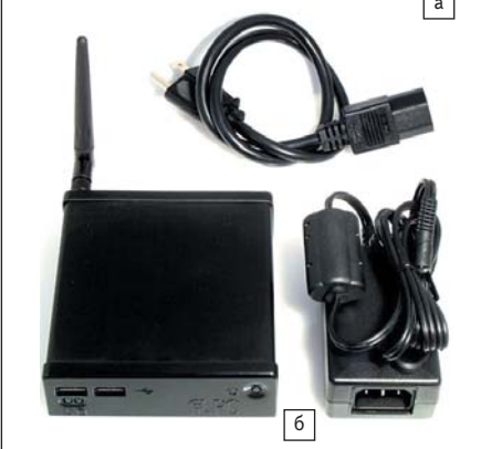
Рис. 7. Внешний вид компьютера Fit-PC Slim: а) интерфейсы; б) питание
