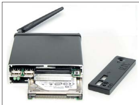
Рис. 8. Компьютер Fit-PC Slim с возможностью смены жесткого диска
